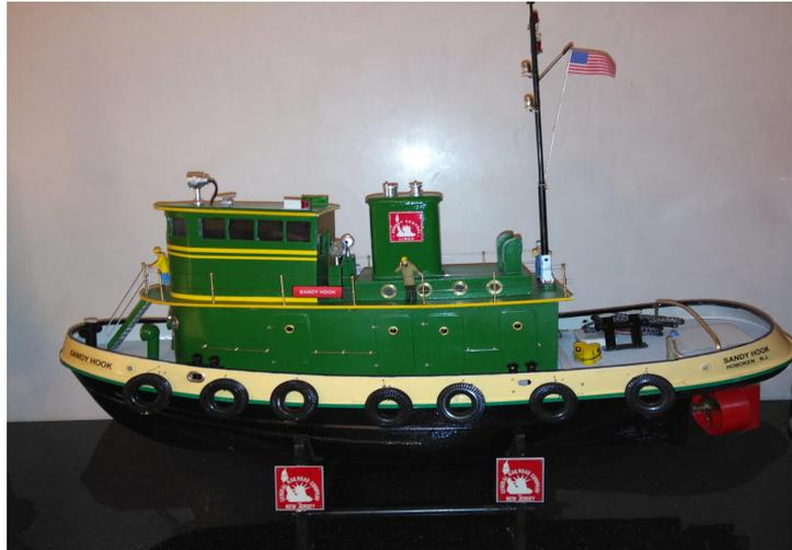
Lackierung: Rumpf schwarz (Acryllack), Bordwand lt. Foto „papayagelb“ Acryllack, Aufbauten laubgrün Acryllack. Zierlinien gelb. Mast schwarz mit Lichtern, theoretisch umlegbar (beim Original für Durchfahren unter Brücken auf dem Hudson-River). Die Beleuchtung ist eingebaut, Stromversorgung über Spannungsregler (von 12 auf 3,5 Volt für LED´s). Nicht originalgetreu, aber für den Betrieb nötig: Kortdüse von Lextec mit 2 eingebauten Ruderblättern, Messing-Propeller 4-Blatt, 35 mm Durchmesser.
