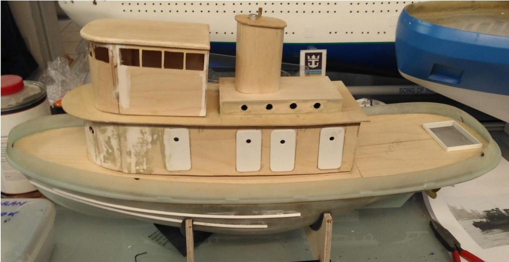
Das „Pilot House“ ist ebenfalls eine 3-Rahmen-Konstruktion (Boden, die gebogene Front und das Oberteil oberhalb der Fensterlaibungen. Abgedeckt wurde mit einem 3 mm starken Balsabrett, das seitlich und frontal leicht über den senkrechten Wänden übersteht. Für Arbeiten am künftigen Ruder musste in Deck (2,5 mm Flugzeugsperrholz) ein Ausschnitt hergestellt werden.
