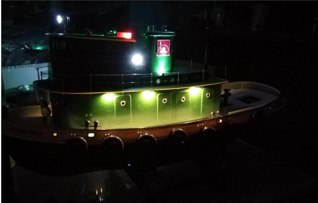
Nachtbeleuchtung an Deck (3 Mini-LED's mit Abschattungsbogen aus Messingrohr, Strahler für's Logo gegenüber Abgaspfosten (alles beidseitig), Pilot-House-Scheinwerfer aus 3mm-LED kaltweiß in Alu-Gehäuse selbst gedreht Man gönnt sich ja sonst nichts...: Linkes Bild: Spielerei mit Ätzteilen an den Türen: Angeln und Riegel sind angebracht - eine Arbeit mit Lupe und Pinzette, nichts für Nervöse...
