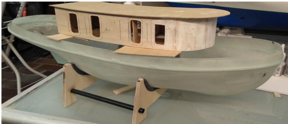
Nach dem Einbau von Motor und Welle nimmt der Aufbau („Erdgeschoß“) schon mal zum „Probesitzen“ Platz. Gebaut nach Fotos mit 1,5/2,5 mm Flugzeugsperrholz auf Rahmen, der die bugseitigen Kurven vorgibt, Ausschnitte für Türen sind angebracht (Gewichtserleichterung). Die Platte auf dem Aufbau ist aus 2,5 mm Sperrholz und stabilisiert die Konstruktion durch Verleimung.
